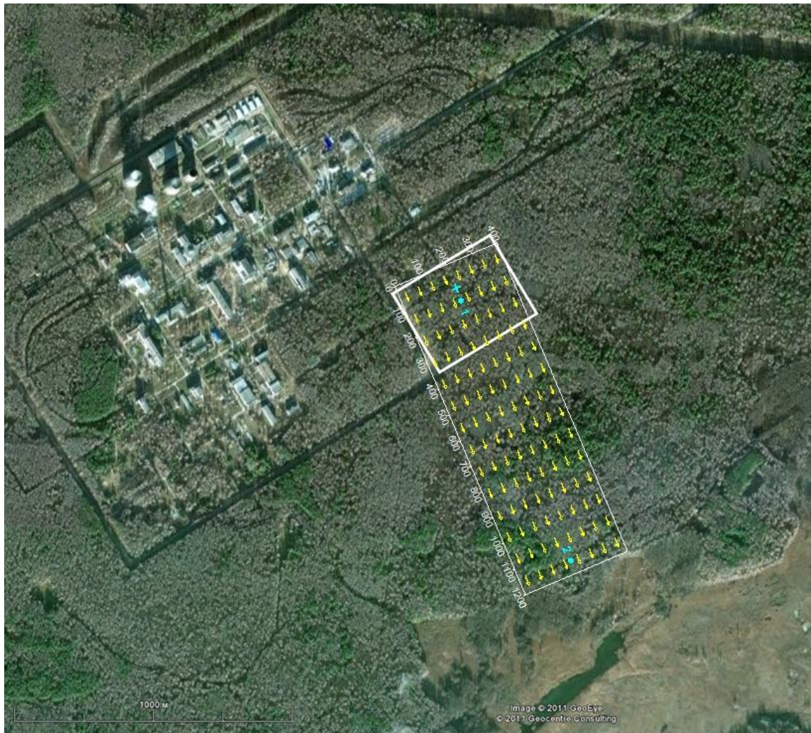
Рисунок 6.1.1.6.5.1 – Расчет горизонтального распределения векторов фильтрационного потока (м/год), крестиком показано предполагаемое место утечки ЖРО
