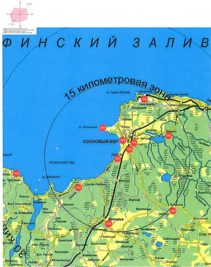
Рисунок 2.1.10.2.2 – Схема размещения постов радиационного контроля в зоне наблюдения ЛАЭС-2
