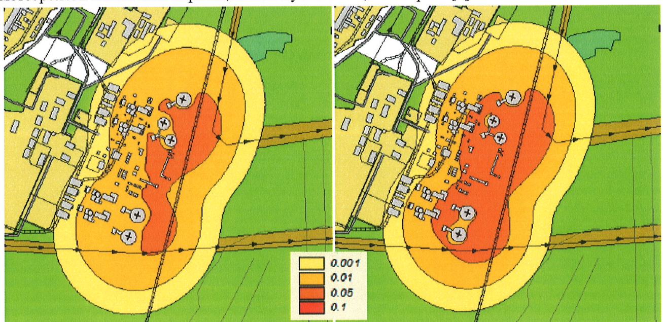
Рисунок 5.4.4.5.4.2.1 – Расчетная интенсивность осаждения воды (мм/час) в среднем за летний (слева) и зимний (справа) периоды
