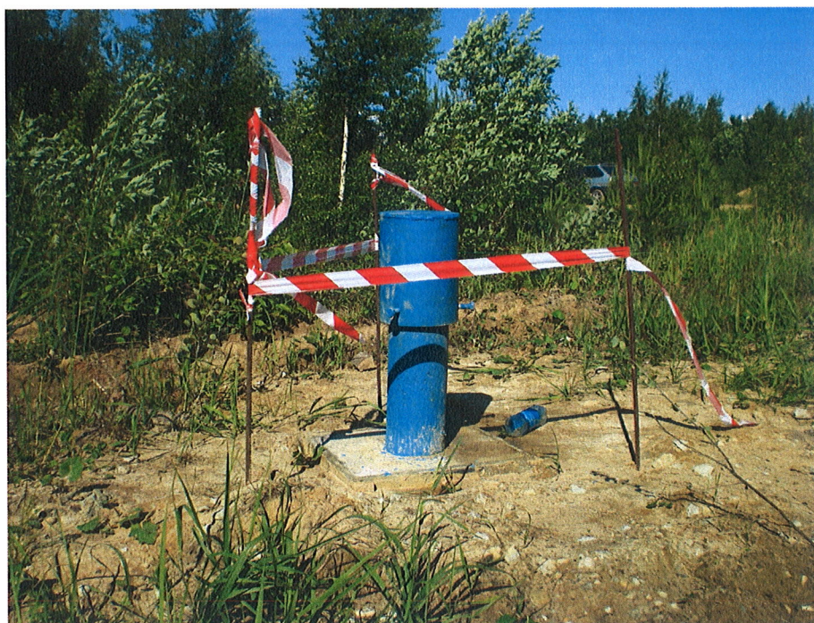
Рисунок 8.2.6.4.1.3.2.2 - Сквazина режимной стационарной гидрогеологической сети на площадке ЛАЭС-2
