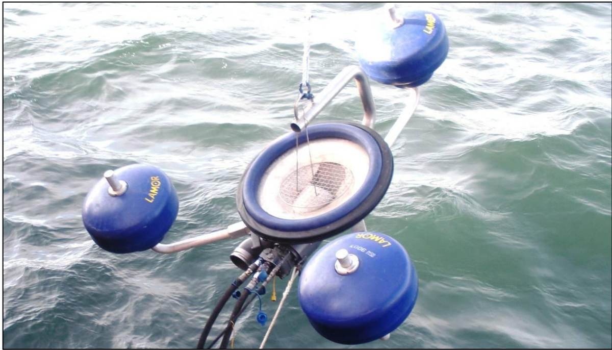
Рисунок 5.5 Пороговый скиммер LWS. Учения «Сахалин Энерджи» по ЛАРН на море в районе ПА
