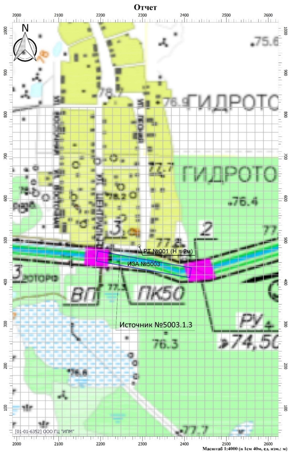
Рисунок 5.13 - Мероприятия по инженерной защите от подтопления территории г. Балахна и его окрестностей, 1 очередь - канал Южный
