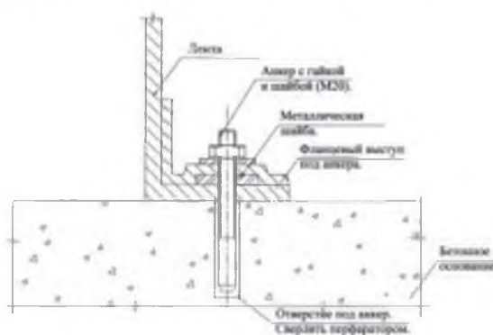
Узел крепления корпуса к бетонному основанию.
