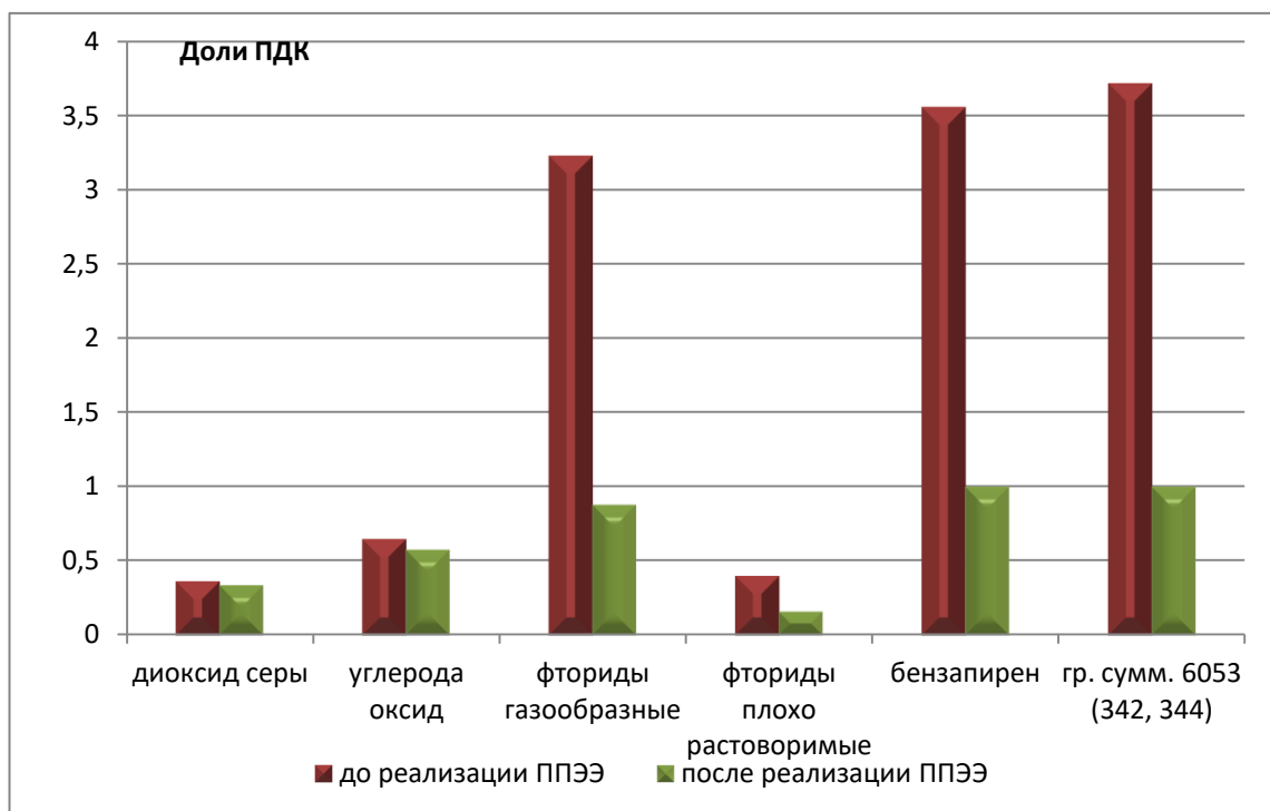
Рисунок 3.5-2. Динамика снижения уровней загрязнения атмосферного воздуха на границе СЗЗ маркерными веществами
