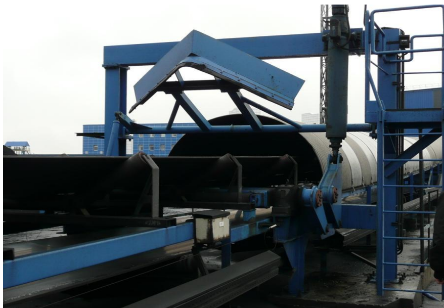
Рисунок 11.1 - Укрытие магистральных конвейеров и устройство для удаления осадков с верха конвейерной ленты.
