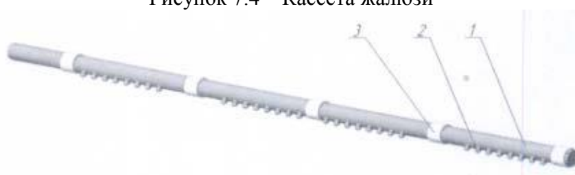
1 – трубопровод; 2 – струеобразующий насадок; 3 - изолятор Рисунок 7.5 – Потокобразователь
