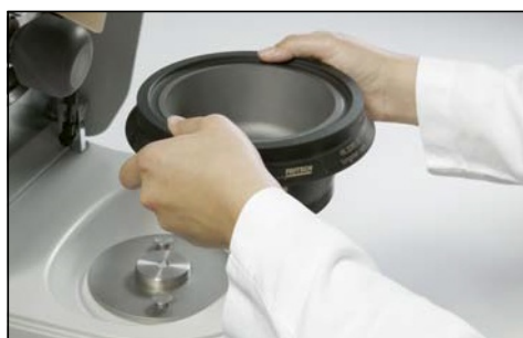
Просто в использовании и особенно надежно: быстроразъемное байонетное крепление ступки
